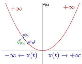
Para que un sistema pueda ser acotado por esta función hasta alcanzar el punto de equilibrio, **este también debe estar en el origen**, por lo que su aplicación en sistemas de control se basa en considerar al error  $e(t)$  como el sistema dinámico a estabilizar, ya que, **sin importar la ecuación de  $\dot{x}(t)$ , el punto de equilibrio del error siempre será cero**
