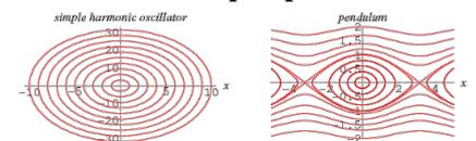
Retrato de fase del conjunto de soluciones de la ecuación diferencial a) de un péndulo simple linealizado y b) de su forma no lineal
